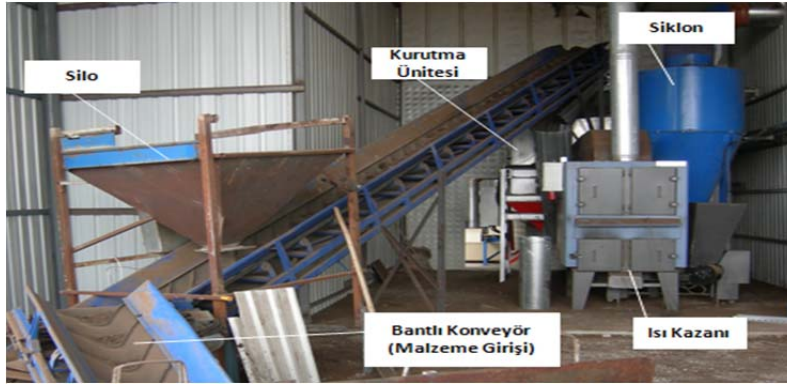
Şekil 4. Üretim hattının birinci kısmında yer alan üniteler
