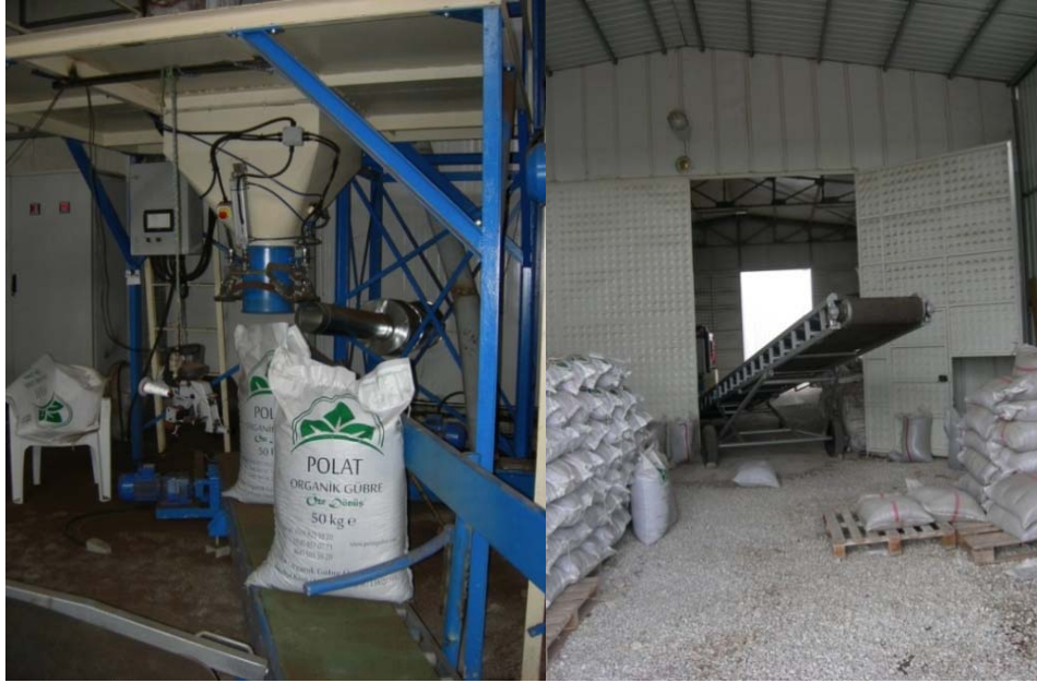
Şekil 6. Ürün tartım, ambalaj ve stoklama üniteleri.
